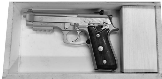
Pistole ohne Magazin in Prüfkiste ISSF mit Einlage Innenmasse 225 x 150 x 50mm
